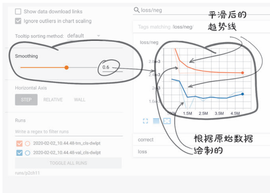
图 11.11 将“平滑”设置为 0.6 并选择 2 次运行以显示的 TensorBoard 边框
