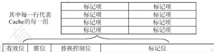
图 3.21 二路组相联的标记阵列示意图
