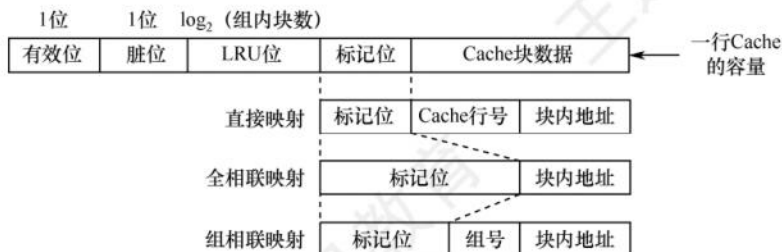
图 3.30 Cache 容量与映射方式的关系
