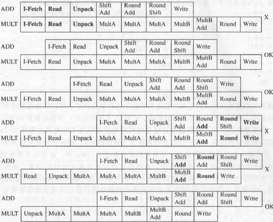
图 20-2 如果每种功能部件只有一个，则 ADD 指令不能和 MULT 指令在同一时间开始执行（因为太多的资源危机，黑体字表示）；也不能在 MULT 之后第 3 个周期（因为 Add、Round 和 Write 部件危机）或者第 4 个周期（Round 危机）执行。但是，如果有两个舍入（Round）部件，则 ADD 可以在 MULT 开始之后的第 4 个周期开始执行。如果再有二个取数部件、多访问的寄存器文件和两个解包器，MULT 和 ADD 就可以同时执行
