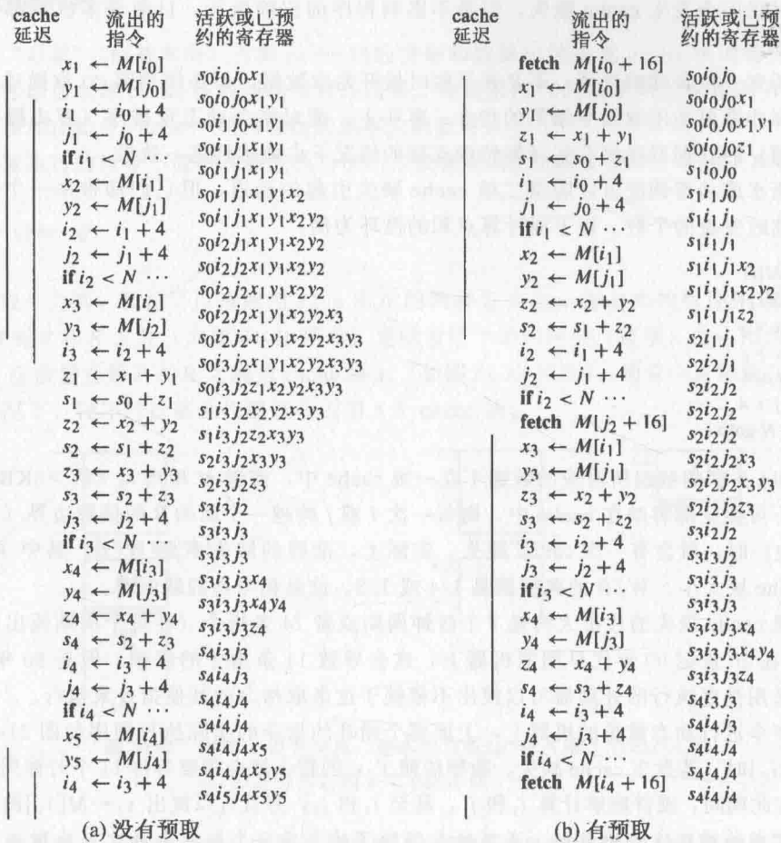
图 21-5 cache 块的大小为 4 个字时，点积循环的执行。(a)没有预取时，在动态指令重排的机器上，未完结的指令数（预约了的寄存器数）随 cache 缺失延迟成比例增长。(b)有预取时，硬件预约表绝不会增大。（这里展示的是稳定状态的行为，不是初始的短暂现象。）
