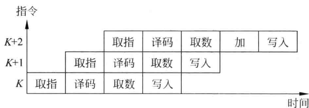
图 6.28 改进后的流水线时空图
