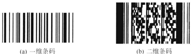
图 9.1 条码符号示意图
