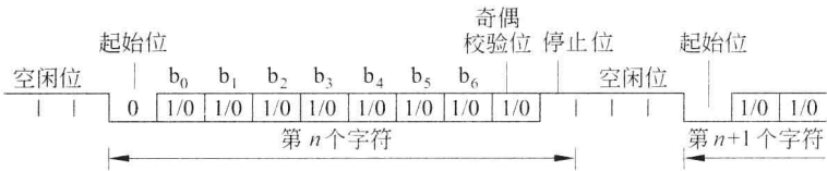
图 10.10 串行异步通信的数据格式
